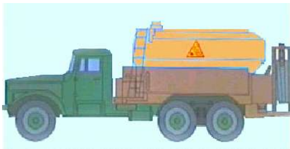
Рис. 7. Змішувально-зарядна машина МЗВ-8
