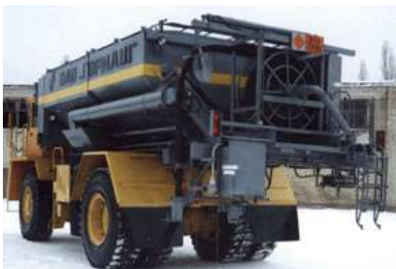
Рис. 9. Змішувально-зарядна машина ТЗЗМ
