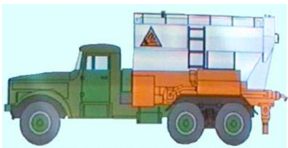
Рис. 8. Змішувально-зарядна машина МЗГ-10
