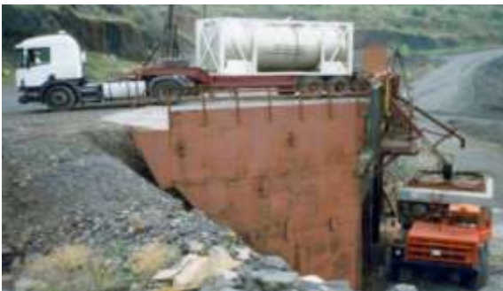
Рис.13. Перекачування емульсійної композиції з автоцистерни “Сканія” в ЗЗМ “Акватол-3”
