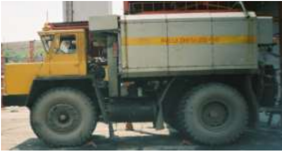
Рис. 12. Змішувально-зарядна машина “Акватол-3”
