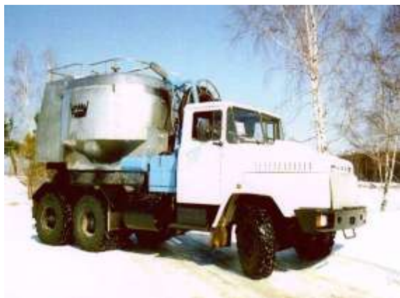
Рис. 10. Змішувально-зарядна машина ЗЗМ-10
